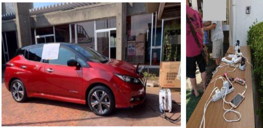
出典：「災害時における電動車の活用促進マニュアル」（経済産業省、日産自動車株式会社） 図6-8 EVからの給電を避難所等で携帯電話充電、扇風機、冷蔵庫等に使用
